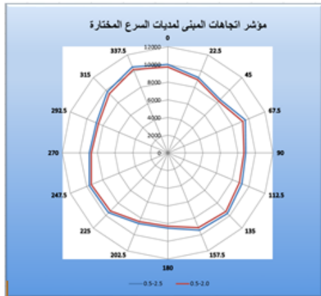
الشكل 13 شكل زهرة الرياح لتوضيح تأثير مديات السرعات المختارة على مؤشر الاتجاهات
